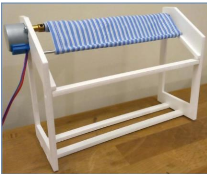
Εικόνα 5.3: Ο βηματικός κινητήρας συνδέεται με τον άξονα με το ειδικό εξάρτημα
