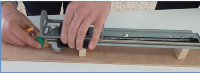
Εικόνα 7.6: Τοποθέτηση μηχανισμού εκτυπωτή και μικροδιακοπών
