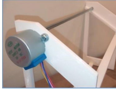
Εικόνα 5.2: Ο βηματικός κινητήρας βιδωμένος στο πλαϊνό στήριγμα
